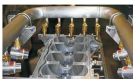
■ 发动机在装配前使用可调式空气增强器和高速空气喷嘴配合进行干燥
