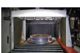
■ 一系列可调空气增强器干燥、冷却一个复杂结构高温的大机械铸件
