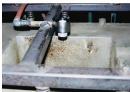
耐高温空气增强器将热空气导至旋转模腔，使塑料部件的壁厚均匀
