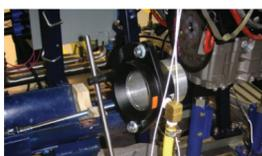
■ 发动机在功率测试时使用 1 个型号 AASP-32 4"(102mm) 空气增强器进行冷却
