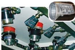
■ 超级空气增强器及扁平喷嘴对加工后传动装置进行吹扫
