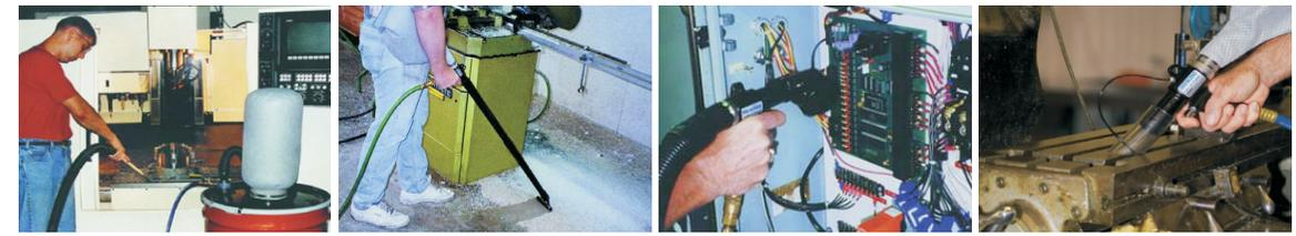
对各种加工中心、车床、锯床、钻床、磨床等机械加工设备加工后的金属碎屑快速清理。
