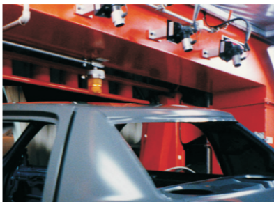
汽车车身涂装前消除静电和污染物
