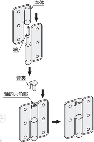
① 将本体插入轴内, 然后将轴套夹插入轴的六角部后, 就可以产生扭矩。拆卸时, 请使用工具等将轴套夹推出。
